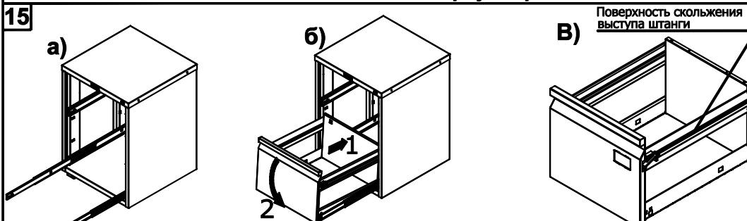
Установку заранее собранных ящиков в корпус картотеки необходимо производить начиная с нижнего, при этом замок картотеки должен быть повернут в положение - "закрыто", соответственно запирающая штанга должна быть в крайнем верхнем положении. Выдвинув несущую часть предварительно установленных направляющих, совместить и завести в соответствующие крепежные элементы в пазы ящика. Запирающий выступ штанги должен располагаться на горизонтальной поверхности ребра ящика (см. рис. В)
