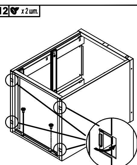
\* - В нижней части корпуса картотеки (на рис. не показано) так же устанавливаются 2 самореза.
